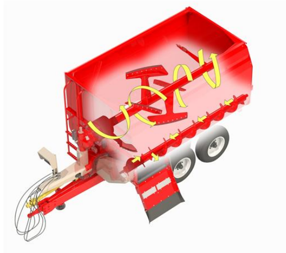
Figura 5. Sentido de fluxo de mistura em vagões misturadores com rotor e pás tombadoras.
