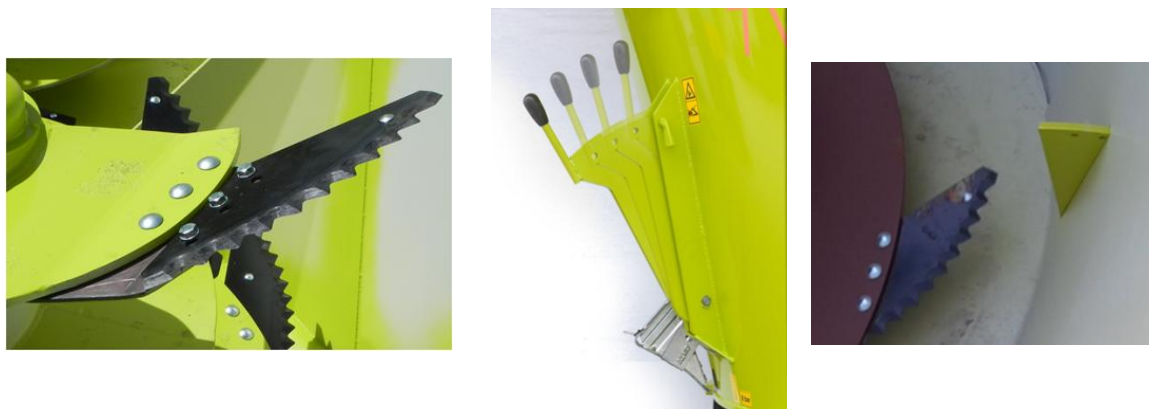
Figura 4. Facas de cortes nas roscas de mistura; Contra facas e opções de acionamento
