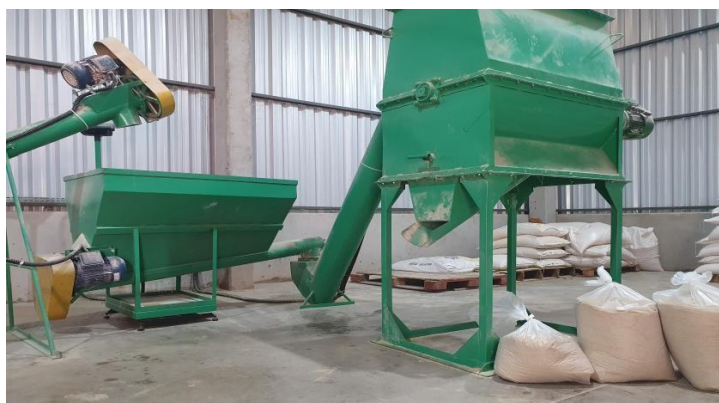
Figura 2. Equipamentos do modelo de fábrica de ração proposto. Fonte: os autores
